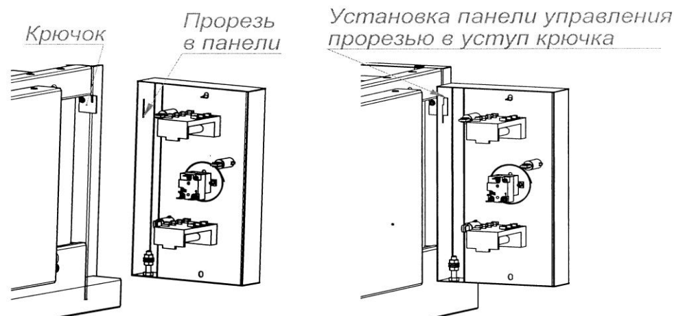
Рис. 11 СХЕМА УСТАНОВКИ ПАНЕЛИ УПРАВЛЕНИЯ ПРИ ТО
